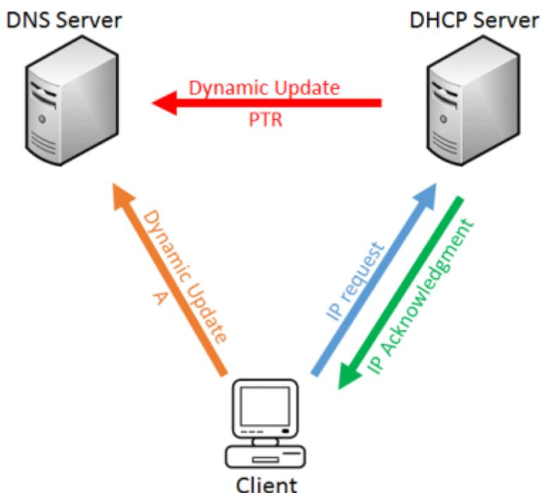
Beim **DDNS** können dann automatisiert DHCP Clients vom ISC-DHCP-Server in die DNS Zonen eingetragen werden und so das Netz dynamisch verwaltet werden.
